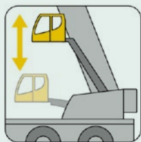
Elevación de cabina a través de brazo telescópico
