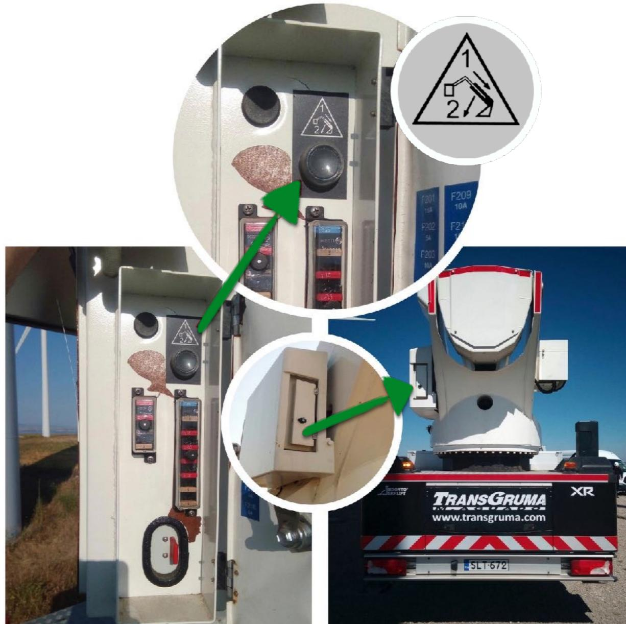
Las PEMP disponen de un sistema de intercomunicación vía radio, con el fin de estar en continua comunicación desde el chasis del camión con los usuarios que se encuentren en la plataforma de trabajo.
