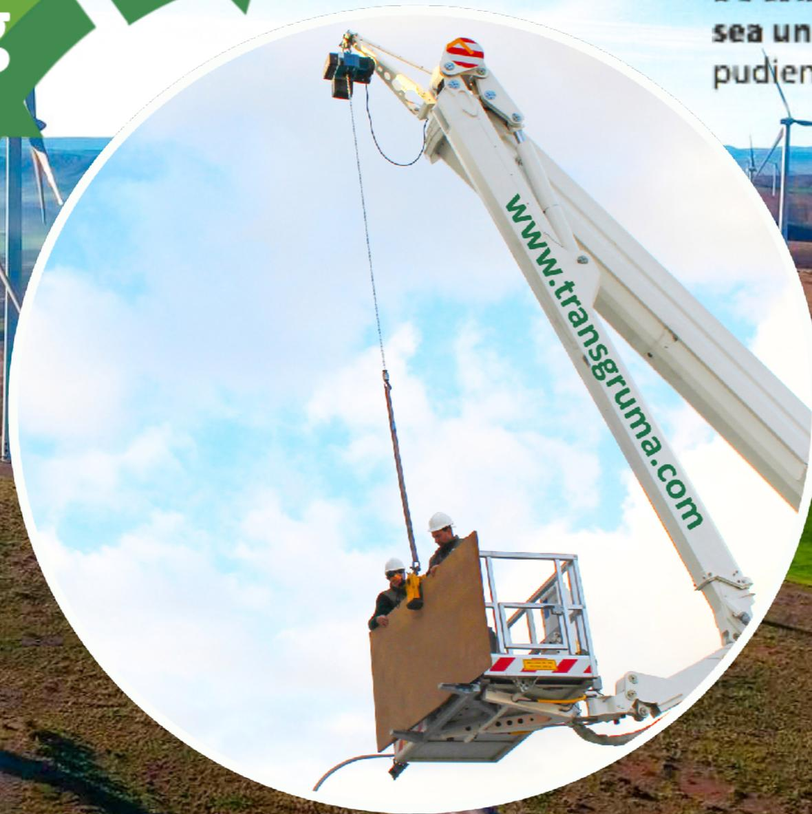
En el caso de un comienzo inesperado de rachas de viento fuerte, **el sistema electrónico de inteligencia de la plataforma únicamente permite realizar los movimientos de descenso de la misma.**
