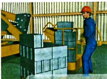
Figura 17. Plataforma de trabajo sobrecargada.
