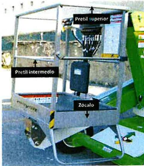
Figura 4. Plataforma de trabajo o cesta. Protecciones perimetrales.
