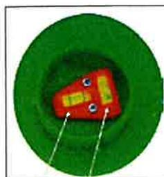
Figura 1. Nivel de burbuja longitudinal y transversal del chasis.
