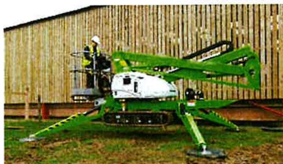
Figura 15. Estabilizadores hidráulicos con placa de apoyo.
