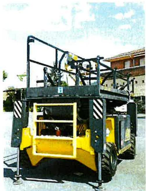
Figura 6. Plataforma de trabajo con protecciones perimetrales plegables.
