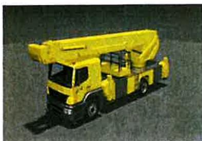
Figura 4. PEMP sobre camión
