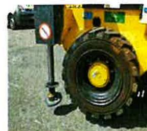
Figura 2. Base de apoyo de un estabilizador.
