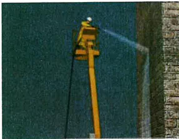
Figura 17. Utilización de manguera a presión con riesgo de superar la fuerza lateral máxima admisible
