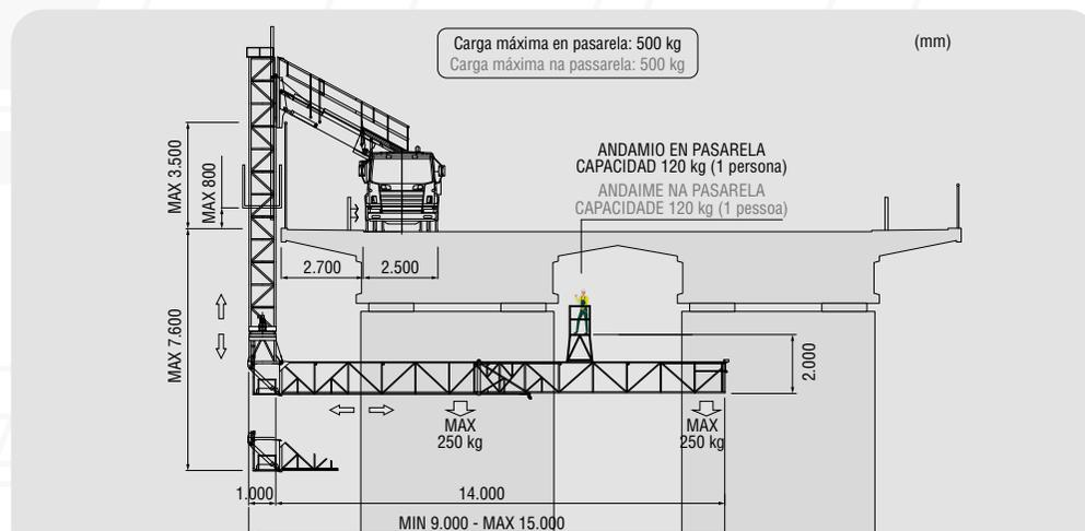
INCLINACIÓN MÁXIMA DEL PUENTE PERMITIDA / INCLINAÇÃO MÁXIMA ADMISSÍVEL DA PONTE ±4° (±7%)
