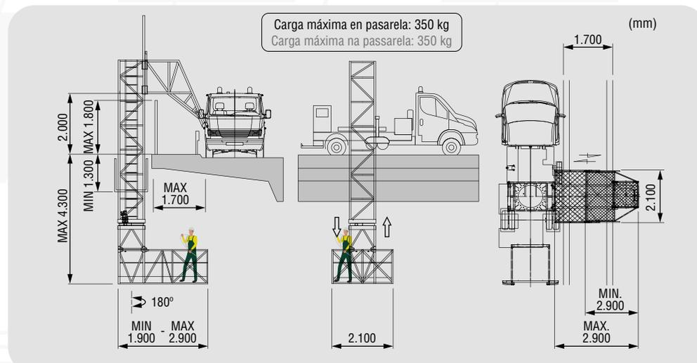
INCLINACIÓN MÁXIMA DEL PUENTE PERMITIDA / INCLINAÇÃO MÁXIMA ADMISSÍVEL DA PONTE ±3° (±5%)
