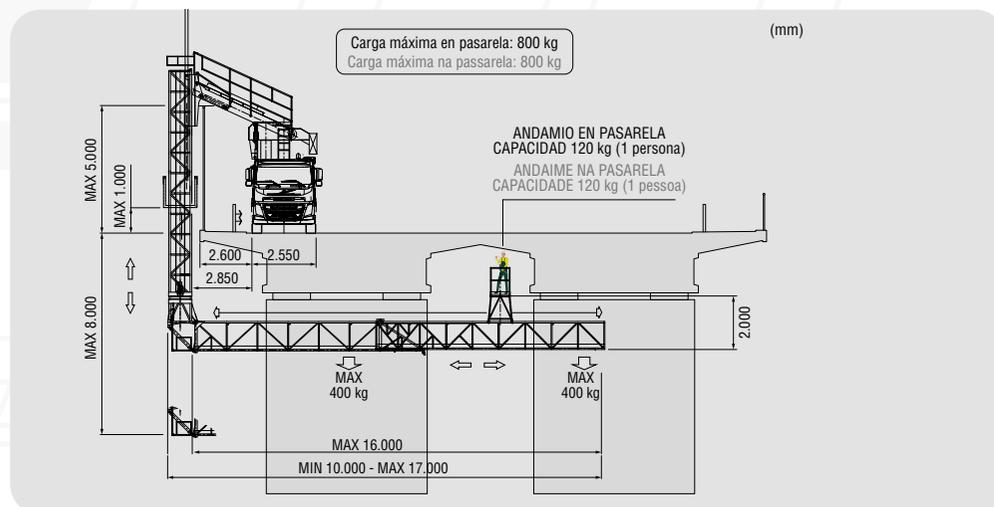
INCLINACIÓN MÁXIMA DEL PUENTE PERMITIDA / INCLINAÇÃO MÁXIMA ADMISSÍVEL DA PONTE  $\pm 4^\circ (\pm 7\%)$
