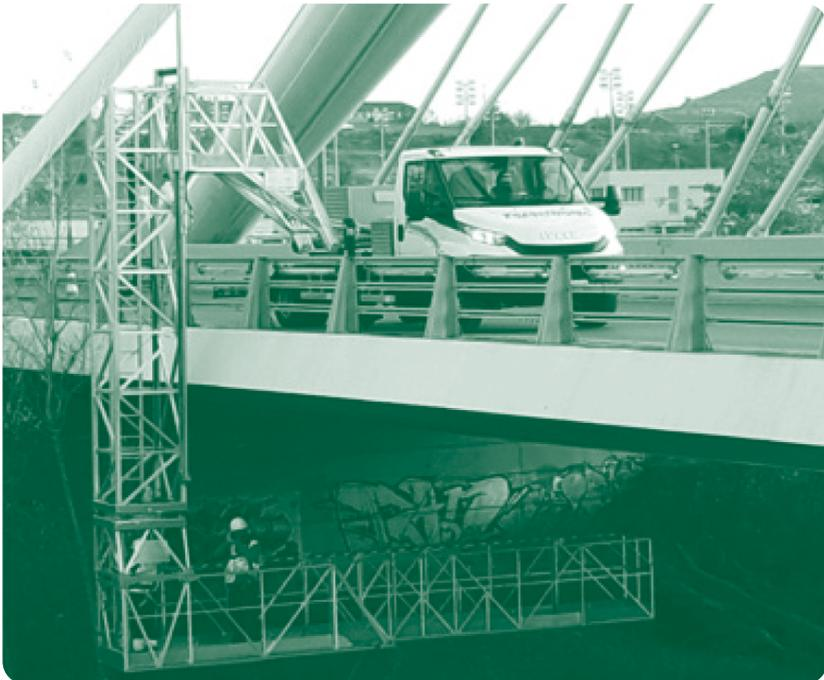
La pasarela elevadora móvil de personal en negativo, en adelante PEMP-N, es una máquina destinada a desplazar personas hasta una posición de trabajo situada a una altura en negativo del nivel del suelo donde se encuentra el vehículo.
